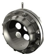
Сбалансированный расходомер DDTOP LGP представляет собой проточный элемент, разработанный на основе стандартной пластины с отверстиями. Его датчик представляет собой дросселирующий выпрямитель из пористого диска, установленный на участке трубы. Размер и распределение каждого отверстия настраиваются на основе данных испытаний и становятся функциональными отверстиями.
