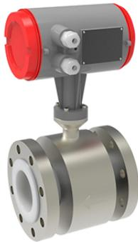
Магнитный расходомер DDTOP LD подходит для проводящей среды с проводимостью более 5 мкСм/см и с широким диапазоном номинального диаметра. Он также подходит для различных условий проводящей среды, где нет потери давления, с различными режимами питания и вывода сигнала. Он использует стандартный последовательный интерфейс связи RS-485 и поддерживает международные общие стандарты протоколов связи MODBUS-RTU, GPRS и другие методы беспроводной и проводной связи.
