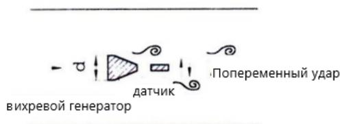
Эти чередующиеся вихри образуют серию чередующихся подъемных сил жидкости. Подъемная сила действует на датчик обнаружения зонд на основе пьезоэлектрического эффекта, генерируя серию сигналов переменного заряда, которые преобразуются, формируются и усиливаются предварительным усилителем. На выходе получается импульсный сигнал с той же частотой, что и при вихревого разделения и пропорционален скорости потока.
