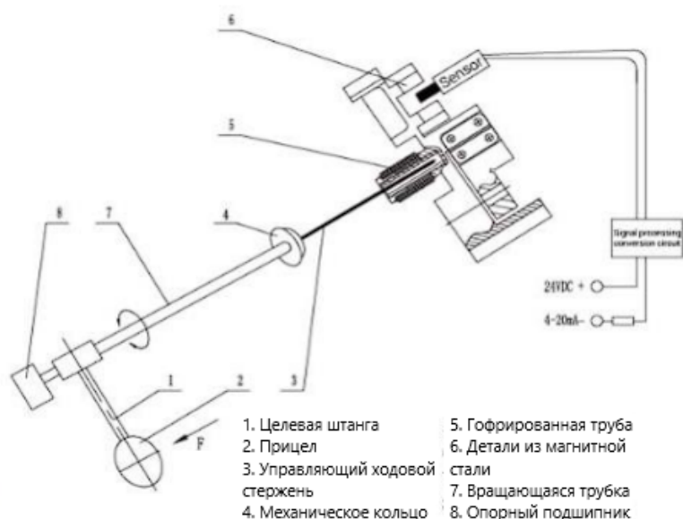
Рис.1 NBLB принципиальная схема целевого расходомера
